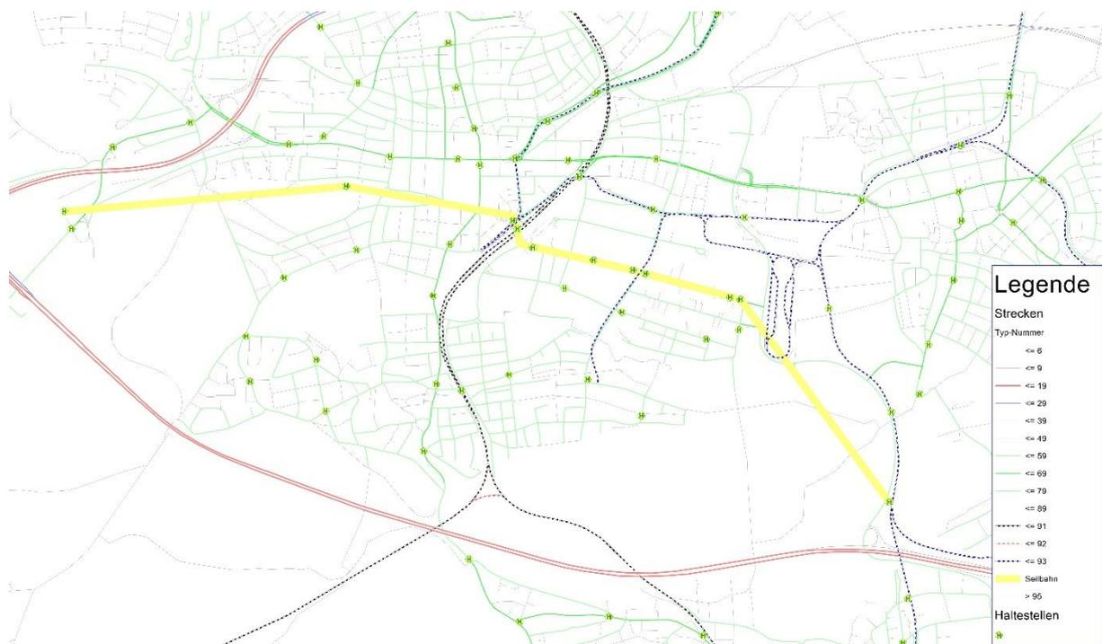
**Abb. 3-3: Integration der Seilbahn als neues Verkehrssystem in das bestehende Netz**
