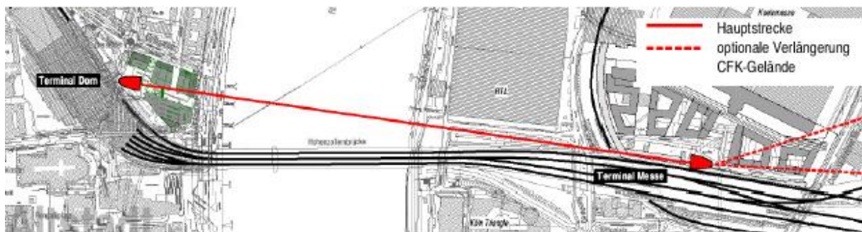
Abb. 5-6: Mögliche Seilbahntrasse in Köln zwischen Hauptbahnhof und Bahnhof Messe/Deutz Quelle: Topp, Hofherr und Müller (2009)
