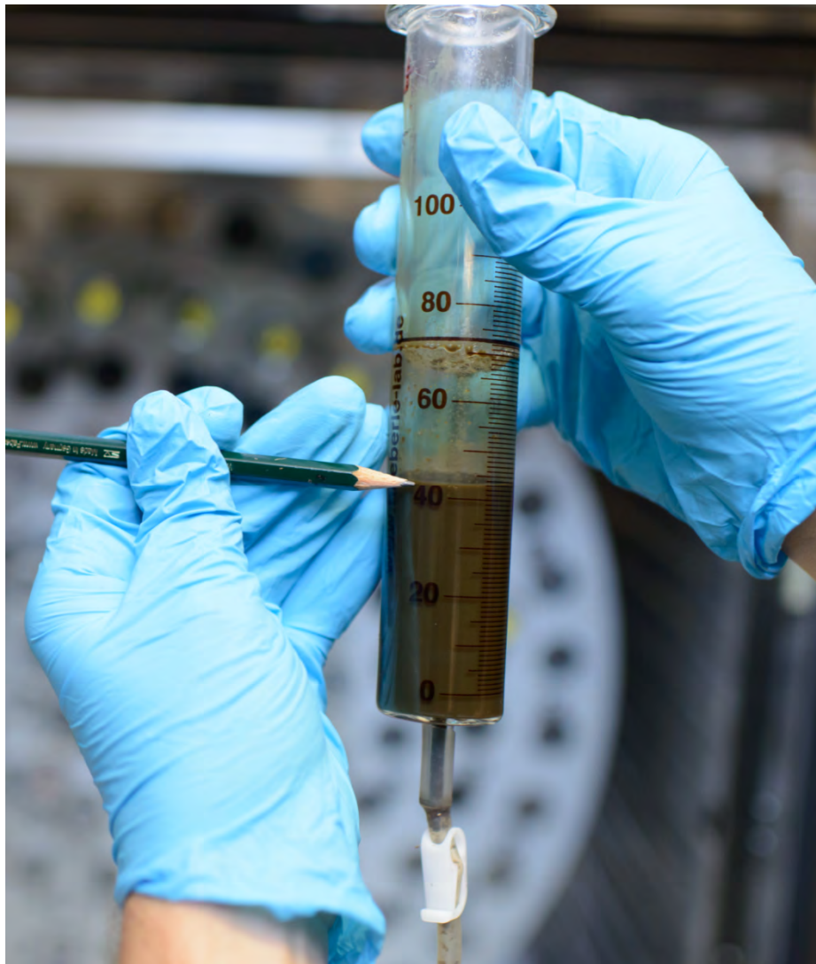
Abbildung 5.1: Gefüllter Kolbenprober des HBT mit Inokulum und Testsubstrat
