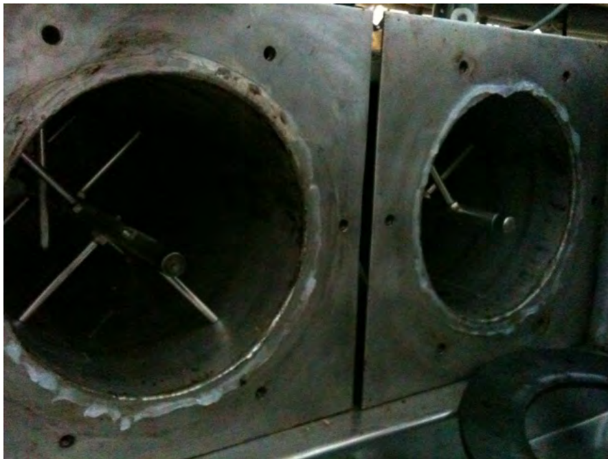
Abbildung 5.5: Fermenter mit Haspelrührwerk des Labor-Durchfluss-Fermenters
