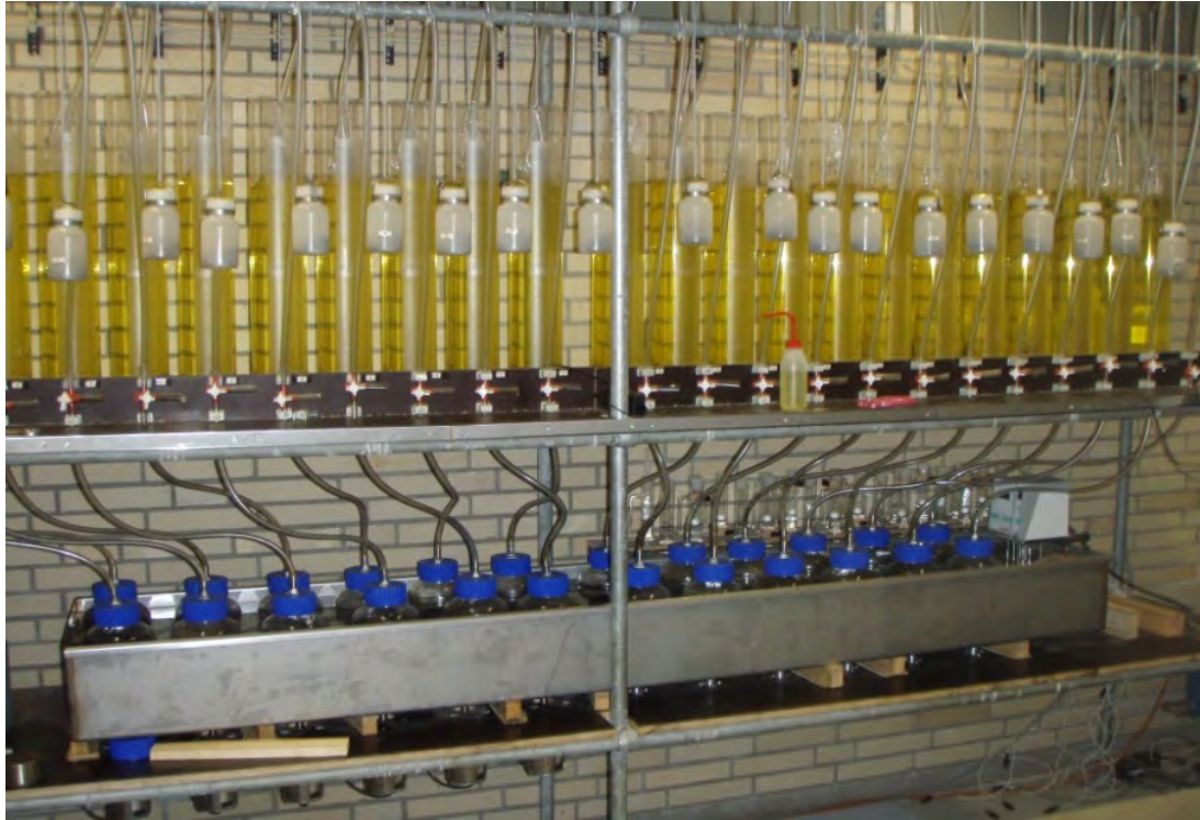
Abbildung 5.4: Aufbau der 2 Liter-Batch-Gärversuchsanlage
