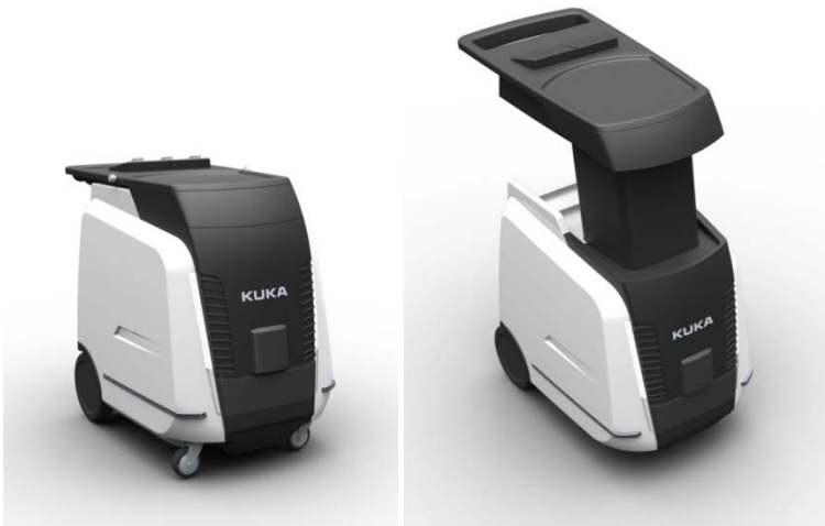
Abbildung 1: der Mobilitätsassistent mit ein- und ausgefahrenem Tisch
