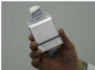
Prototyp einer 100 mAh ORB mit 35 W Leistung; 4 Stück davon genügen um einen Desktop PC bei Stromausfall sicher auszuschalten
