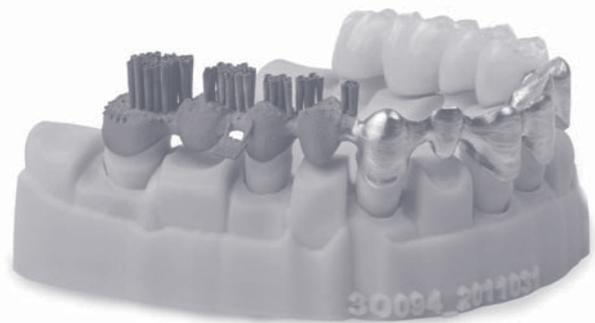
Die Abbildung zeigt drei Phasen des additiven Herstellungsprozesses: links die Brücke unmittelbar nach dem Bauprozess (noch mit Stützstrukturen), auf den vorderen Zähnen die polierte, hinten die mit Keramik verblendete Brücke. Quelle: © EOS Electro Optical Systems
