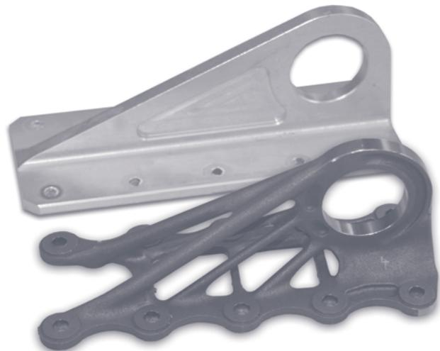
Durch seine bionische Struktur erreicht dieser additiv gefertigte Kabinenhalter (unten) eine Gewichtseinsparung von über 30 % gegenüber seinem konventionell hergestelltem Pendant (oben), erfüllt aber dieselben Vorgaben hinsichtlich Funktionalität und Festigkeit. Quelle: © Airbus Operations GmbH
