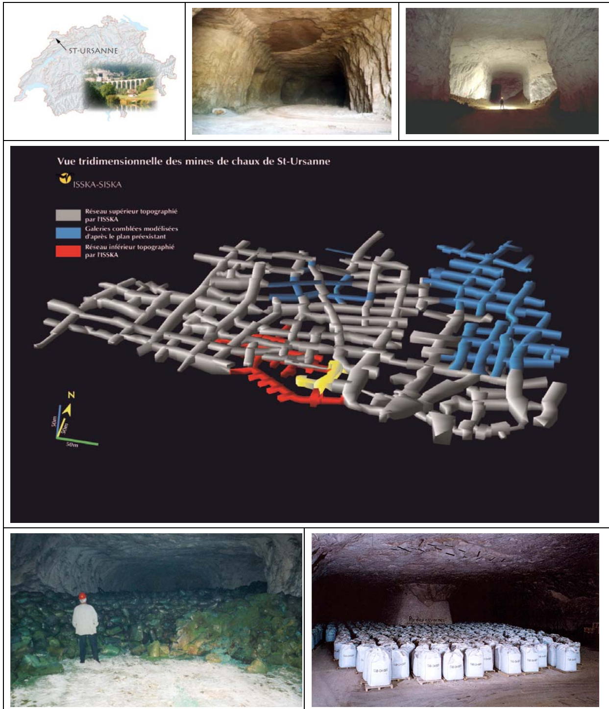
Figur 3: Eindrücke des Kalkbergwerks von St-Ursanne Oben: links: Standort Mitte und rechts: Galerien Mitte: Modell des Bergwerks nach Schweizerisches Institut für Speläologie und Karstologie Unten: links: Zwischenlager kupferhaltiger Metallhydroxid-Schlämme rechts: Metallhydroxid-Schlämme in Bigbags abgesackt vor Abtransport
