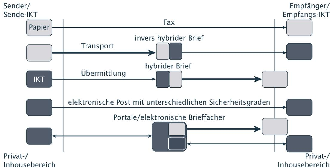
Helle Rechtecke stehen für Papier, dunkle für elektronische Datenträger; dicke Pfeile stehen für physischen Transport, dünne für elektronische Übermittlung. Die senkrechten Striche trennen den Privat- bzw. Inhousebereich mit Zugangspunkten zum Netz von der Netzinfrastruktur.
