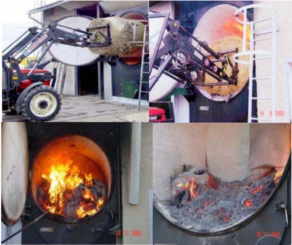
Abb. 22: Beschickung und Abbrand des Ganzballenvergasers
