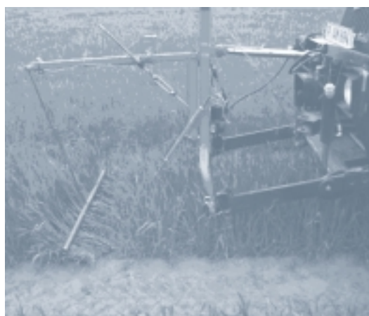
ABB. 5 CROP-METER ZUR MESSUNG DER PFLANZENMASSE-DICHTE FÜR DIE STICKSTOFFDÜNGUNG
