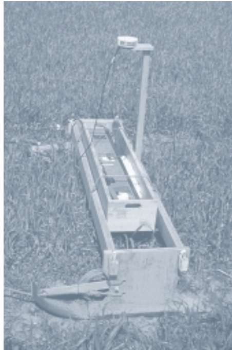
GERÄT EM38 ZUR MESSUNG DER ELEKTRISCHEN BODENLEITFÄHIGKEIT
