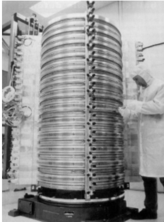
Abb. 13: Leistungserzeugungseinheit des HF-Lasers Alpha
