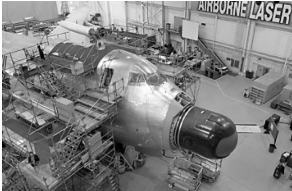
Abb. 15: Montage des Airborne Laser in einer Boeing 747-400F
