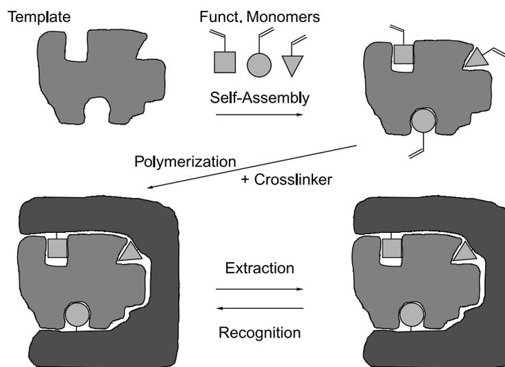
Erläuterung: Das prägende Molekül (Templat) bildet mit geeignet funktionalisierten Molekülen ein Supermolekül. Durch Zugabe und Polymerisation von (organischen oder anorganischen) Netzwerkbildnern wird der molekulare Abdruck gewonnen, der nach Entfernen des Templatmoleküls durch molekulare Erkennung die gewünschte hohe Selektivität aufweist.
