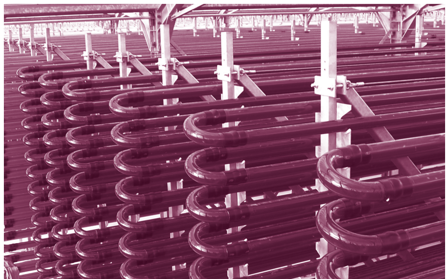
ABB. 1 BEISPIEL FÜR EINE GESCHLOSSENE KULTIVIERUNGSANLAGE FÜR MIKROALGEN
